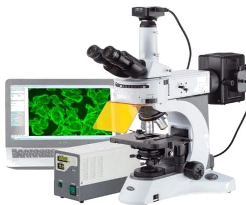
**Figura 1.6.** Microscopio de fluorescencia
